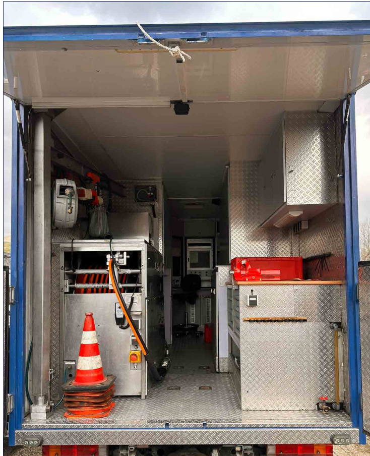
Touret de câble du véhicule de fraisage KASRO transformé
